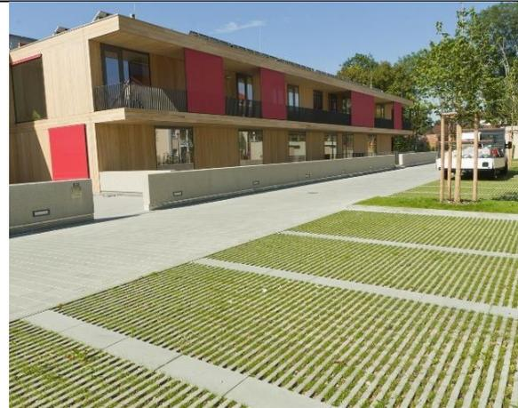
**Abb. 95: Beispiel eines Rasenfugenpflaster-Parkplatzes (RINN BETON- UND NATURSTEIN GMBH & Co. KG o.J.: [www](http://www))**
