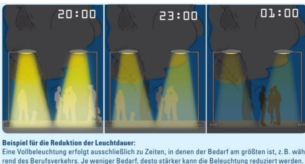
Abb. 158: Beispiel für eine nächtliche Leistungsreduzierung der Beleuchtungsstärke (STMUV 2020a: 8)
