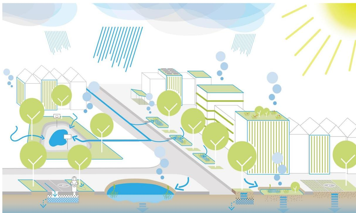
**Abb. 6: Das Schwammstadtprinzip: So viel Grün wie möglich in Kombination mit Regenwassermanagement (STMUV 2020c: 8)**
