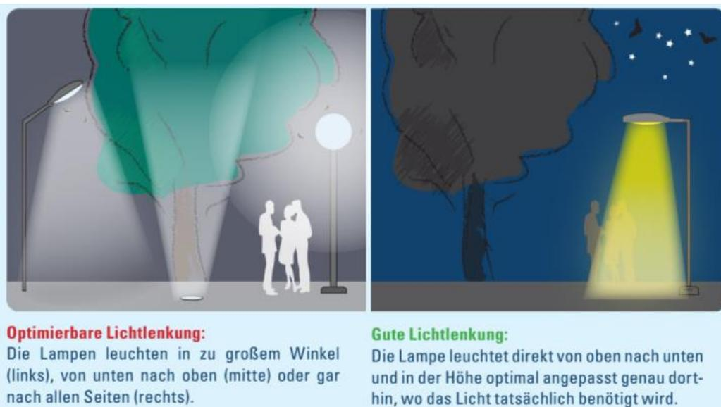
Abb. 157: Verringerung der Lichtimmissionen durch optimierte Lichtlenkung (STMUV 2020a: 7)
