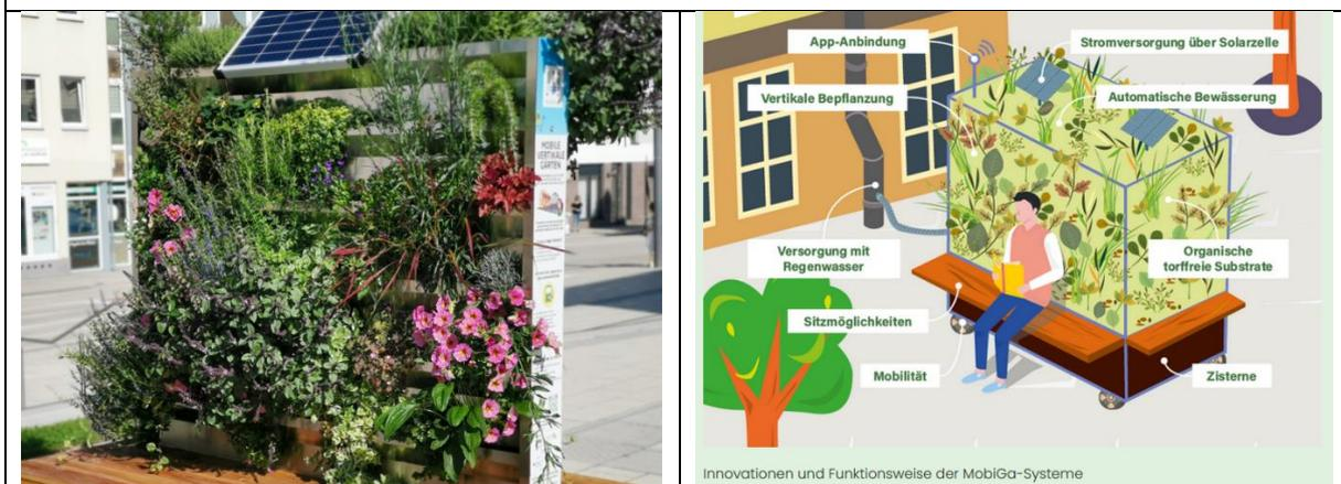
**Abb. 138: Ausgeklügelte rollende Beete mit Wasserspeicher und autarker Energieversorgung für Wasserkreislauf (MOBIGA 2022: [www](http://www))**
