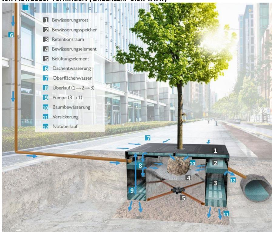
**Abb. 80: Komplexere Ausführung einer Baumriegele mit direktem Anschluss an Regenrohr und automatischem Bewässerungssystem (FH MÜNSTER o.J.: www)**
